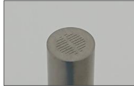
ガストース先端部 (エジェクタピン、コアピンタイプ)
