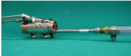
ガストースをリングマグネットに密着させ銅棒に差し込みます。
