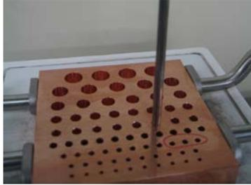
銅板にガストースを立て樹脂の溶解温度まで加熱します。
