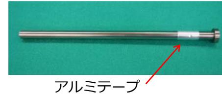
ガストースの横穴を塞ぐ為に、適当な大きさにカットしたアルミテープを巻きつけます。
