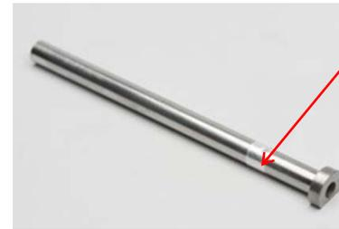
ガストースの横穴を塞ぐ為に、適当な大きさにカットしたアルミテープを巻きつけます。
