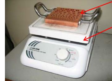
厚さ15mmの銅板にガストースが入る穴をあけ、ホットプレートに銅板を載せます。
