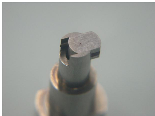
先端はスライド式で交換 (取り外し)できます。
