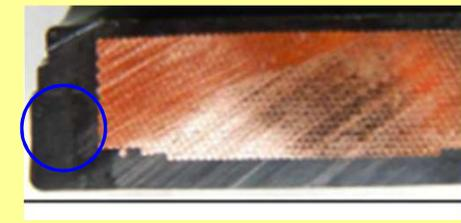
ガストース使用した事で、製品内に発生していた気泡(ガス)が無くなった。
